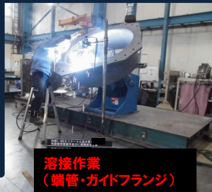
内径1,350ミリメートル送水管 布設替用管製作並びに現場接合工事 平成 28年 12月 天候 晴れ 工種 溶接作業
