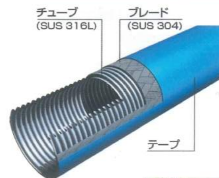
SDF管の内部構造
