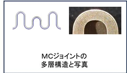
当社若手技術者が、ペローズ成形システム開発の過程で、失敗した試作品の不揃いの山々から着想したのがMCジョイント(Metal Corrugated Joint)です。元来、ペローズ(均一ジャバラ形状)自体は100年以上も前にドイツが発祥とされており、これまでは構造、形状ともほぼ不変で一様でしたが、MCジョイントはそれらとは一線を隔す、まさに革新的な独創製品です。管路に作用する軸方向伸縮・軸直方向変位・角度変位等を吸収するペローズの伸縮可撓性能は、これまでも各分野で防災減災に大いに資するものでありましたが、MCジョイントはその従来型ペローズでは困難であった、極めて短面間での大変位吸収と「全方位可動余力」を同時に確保、実現しました。
