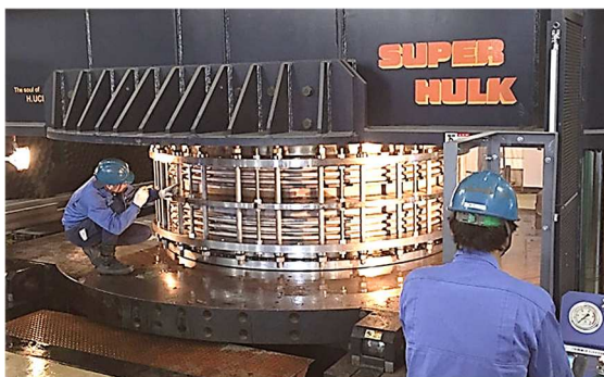
世界最大級 液圧ベローズ成形機 【SUPER HULK】
